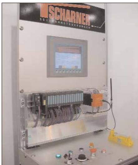
SPS-Steuerung, von der aus die Lego-Bahn betrieben wurde.
